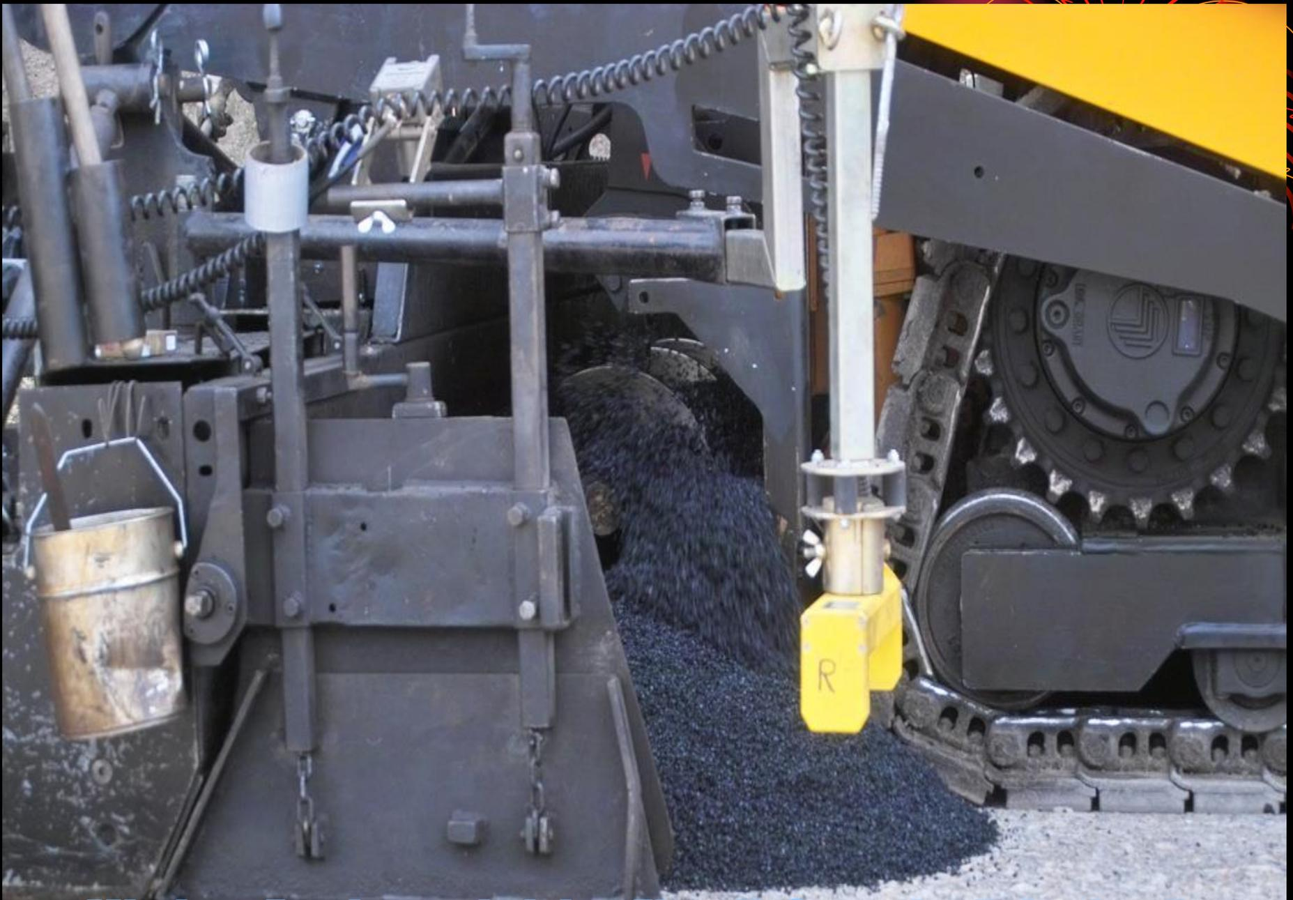
**Mit dem Fertiger wird das Elastik Granulat "planiert".**
